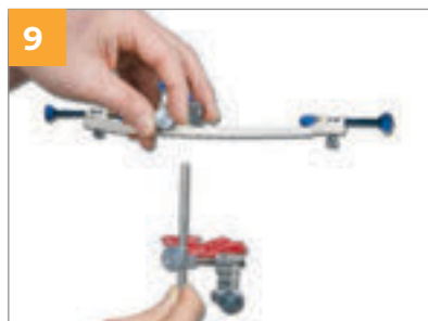
Allentare il pomello ed estrarre il blocco porta forchetta. Loosen the knob and take away the fork holder block.
